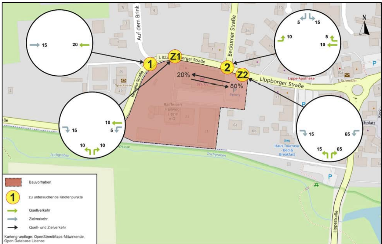
Abbildung 4: Räumliche Verteilung des mit dem Bauvorhaben verbundenen Pkw- und Lkw-Verkehrs (Kartengrundlage: Openstreetmap.org [5])
